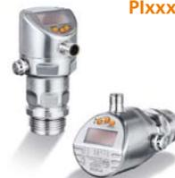
Il sensore di pressione con membrana affiorante è dotato di una cella di misura in ceramica resistente ai picchi di pressione e ai sovraccarichi. Resiste in modo permanente ad una temperatura del fluido di 150°C. IO-Link consente non solo la trasmissione digitale del valore misurato senza perdite, ma anche la parametrizzazione e la fornitura dei dati diagnostici.
